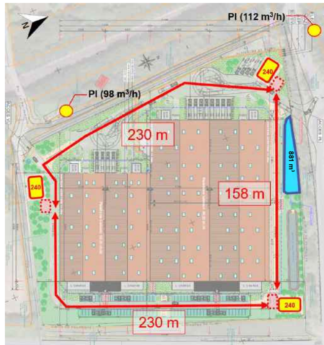
Figure 11-2 : Points d'eau incendie du site
